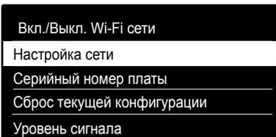
7. После нажатия ОК, котёл создаст Wi-Fi точку доступа для настройки подключения, которая будет активна в течении 10 минут.
